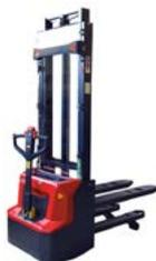
Avec mât poutre «smart view» pour voir jusqu'à 60% de la longueur des fourches - Parfait pour les applications légères à modérées - 5 hauteurs de mât de 1600 à 3600 mm Longueur hors tout : 1710 mm - Batteries lithium à charge rapide avec chargeur intégré 25 Ah - Carte d'accès RFID - Timon ergonomique et intelligent équipé d'un vérin à gaz de série, manipulable en position verticale
