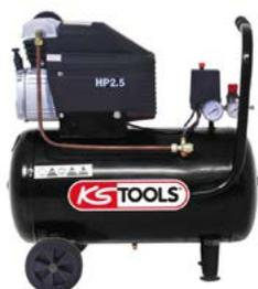
Compresseur coaxial destiné aux petits travaux de bricolage ne nécessitant pas de débits d'air importants - Moteur électrique avec protection thermique - Pressostat avec manomètre - Taux de charge idéal : inférieur ou égal à 50% - Livré avec deux manomètres (cuve et pression de travail) - 2 sorties d'air régulées 1/4" - Motorisation 2CV
