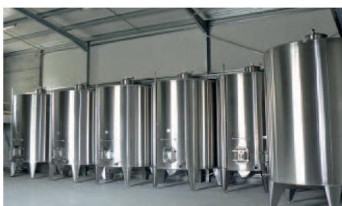
Cuve de stockage fermée à fond conique sur pieds et bombé avec puisard
